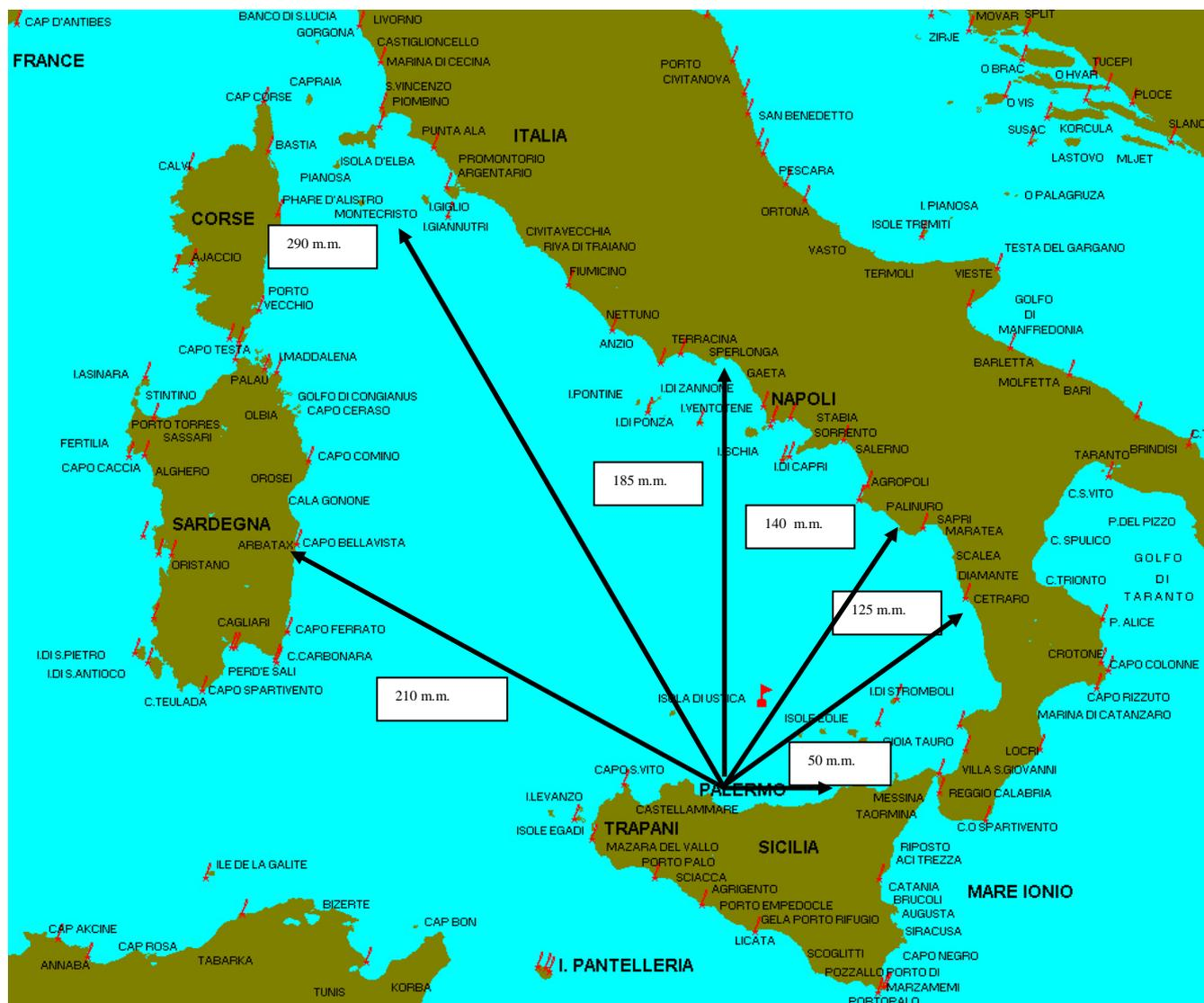
In particolare il porto di Termini Imerese è rivolto verso N-NE e risulta quindi protetto dai mari provenienti dai settori che vanno da O-NO a E, con un settore di traversia geografico (praticamente coincidente con quello principale) che va da 300°N (Capo Zafferano) a 90°N (Capo Cefalù).
